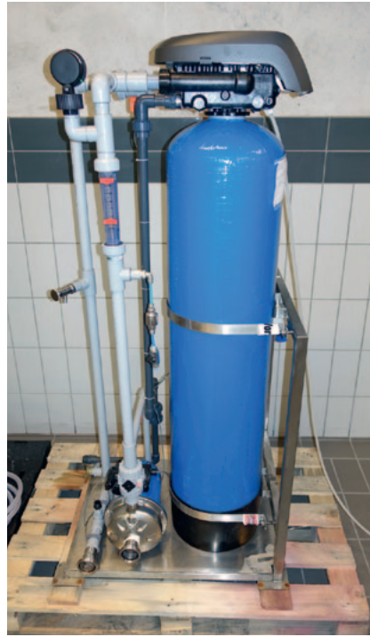
Abb. 3: Ionenaustauscher-Anlage EVER Stabstar 50 (EVER s.r.l.)
