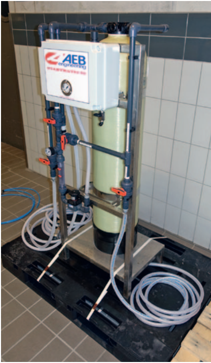
Abb. 2: Manuelle Ionenaustauscher-Anlage Stabymatic 25 (AEB S.p.A.)
